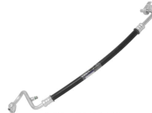
MG-11109C LÍNEA DE DESCARGA
