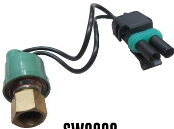
SW9808 SWITCH 1/4" HEMBRA/ CERRADO 180 PSI/ABIERTO 265 PSI
