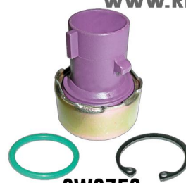
SW9758 SWITCH HARRISON 2 PUNTAS (AZUL)/ CERRADO 283 PSI/ ABIERTO 2100 PSI
