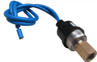
SW9814 SWITCH M10-1.25 HEMBRA/ CERRADO 250 PSI/ ABIERTO 100 PSI
