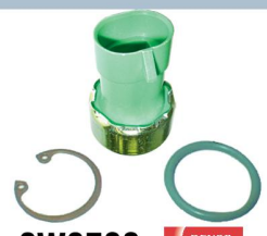
SW9783 DENSO 1.0S/ CERRADO 365 PSI/ ABIERTO 460 PSI
