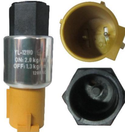
SW7032 SWITCH PARA R134 HEMBRA M12-P1.5 (AMARILLO)
