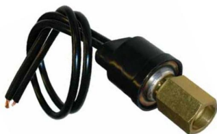
SW9812 SWITCH M10-1.25 HEMBRA/ CERRADO 260 PSI/ABIERTO 200 PSI
