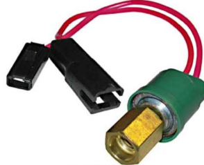
SW9800 SWITCH M10-1.25 HEMBRA/ CERRADO 34 PSI/ABIERTO 6 PSI
