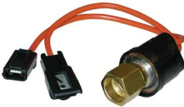
SW9798 SWITCH 1/4" HEMBRA/ CERRADO 34 PSI/ ABIERTO 6 PSI
