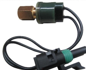
SW9813 SWITCH M10-1.25 HEMBRA/ CERRADO 225 PSI/ ABIERTO 275 PSI
