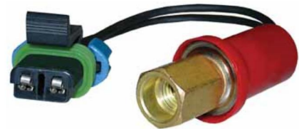
SW9811 SWITCH M10-1.25 HEMBRA/ CERRADO 240 PSI/ ABIERTO 285 PSI
