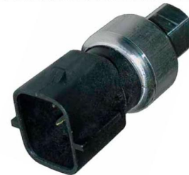
SW9795 M10-1.25 HEMBRA/ CERRADO 265 PSI/ ABIERTO 450 PSI, 4 PUNTAS CHICO CONECTOR CUADRADO
