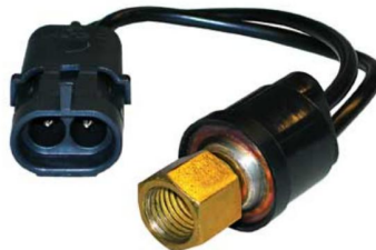
SW9809 SWITCH 1/4" HEMBRA/ CERRADO 250 PSI/ ABIERTO 190 PSI
