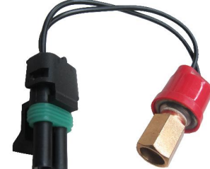
SW9802 SWITCH M10-1.25 HEMBRA/ CERRADO 300 PSI/ ABIERTO 250 PSI
