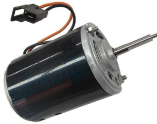
ME9950 MOTOEVAPORADOR 12 VOLTS VELOCIDAD SENCILLA 5/16" (GIRA A LA IZQUIERDA)
